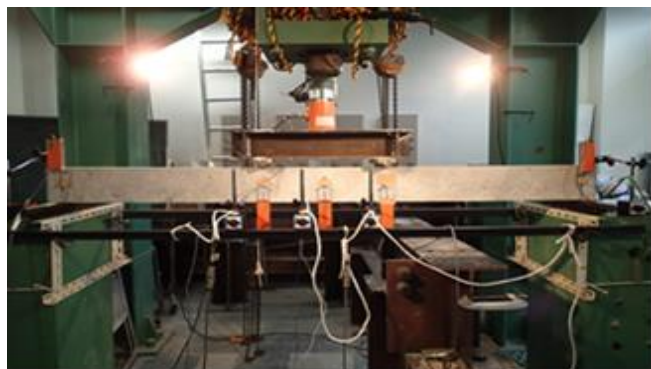
写真-1 梁の静的載荷実験の状況
