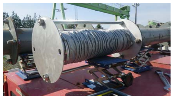
図-2 枝管長調整機構
