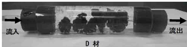
写真 1 D 材を封入した流水条件におけるカラムテスト
