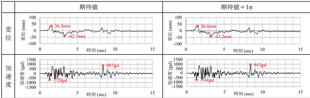
図-2 水平変位および水平加速度時刻歴 ( $\theta_x = \theta_y = 30$  の場合)
