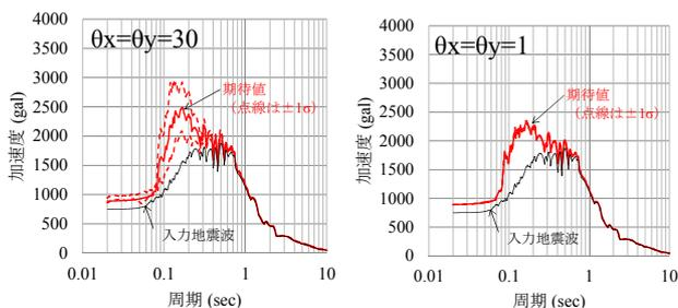
図-3 水平加速度応答スペクトル (減衰定数  $h=0.05$ )
