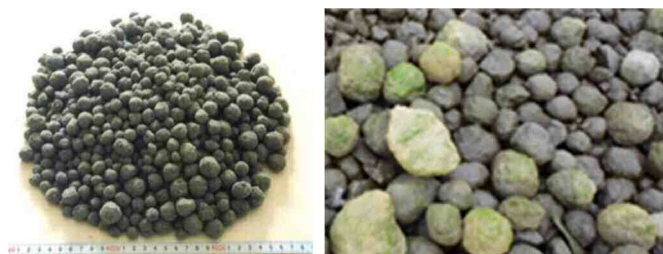
写真-1 (a)石炭灰造粒物, (b)石炭灰造粒物覆砂状況
