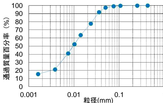
図2 固形物の粒径加積曲線
