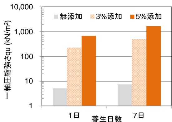
図5 改質土の一軸圧縮試験結果
