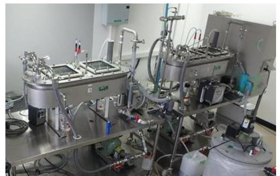
写真-1 固定床式嫌気ディッチのラボスケール試験機
