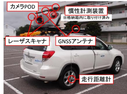
図-1 モバイルマッピングシステム (Trimble MX8)
