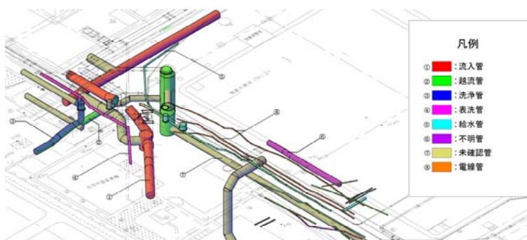
図-5.1 既設埋設管の3D図化
