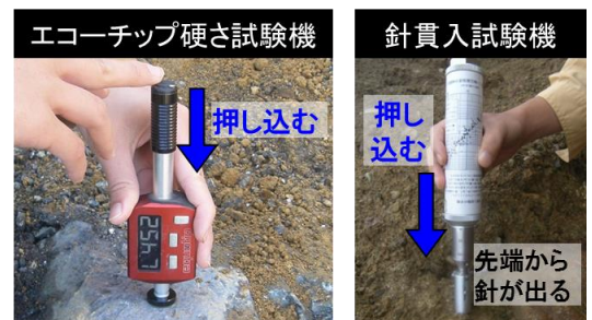
写真-1 エコーチップと針貫入試験機
