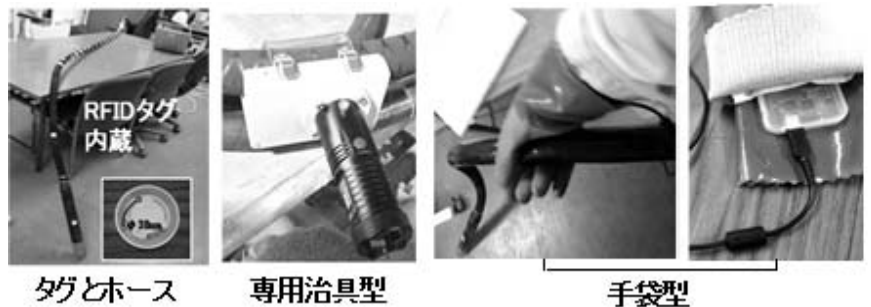
写真-2 RFID タグとバイブレータホース
