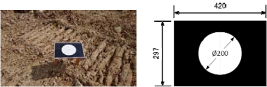
図-2 UAV 写真測量に用いた対空標識
