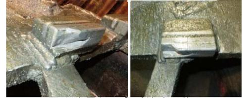
図-8 多層タイプの割れ欠け状況
