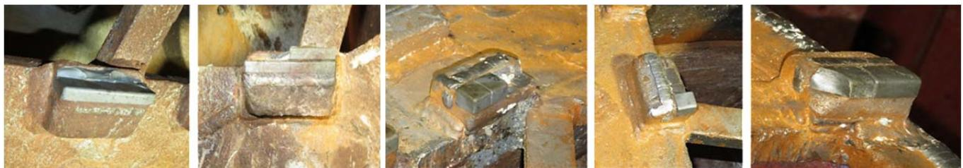
図-13 多層タイプの割れ欠け状況 (2か所)
