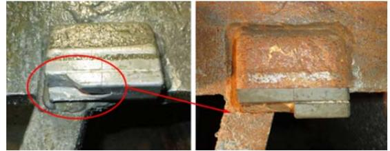
図-10 多層タイプの割れ欠け状況
