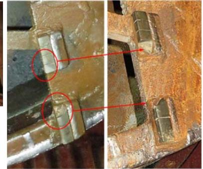
図-11 単層タイプ割れ欠け状況
