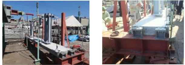
写真-5 水平載荷試験
