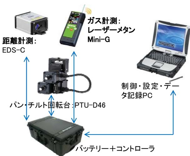
図-1 計測器の基本構成
