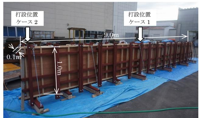
図-1 打設位置と試験体概要
