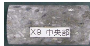
(1) 深さ GL-17.9m (No. 1) (径 101mm, 長さ 193mm)
