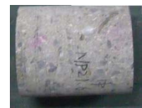
(2) 深さ GL-25.4m (No. 1) (径 101mm, 長さ 126mm)
