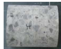
(3) 深さ GL-29.9m (No. 1) (径 103mm, 長さ 119mm)
