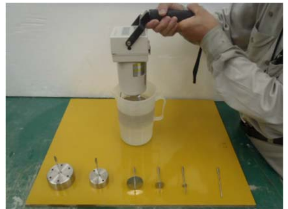
写真-1 粘性係数の測定状況
