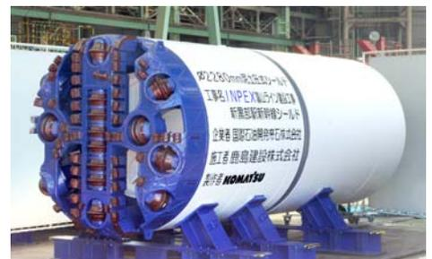
写真-2 シールド機(外径 2,280mm)
