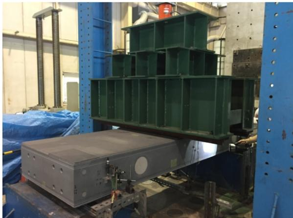
写真-1 単体曲げ試験状況
