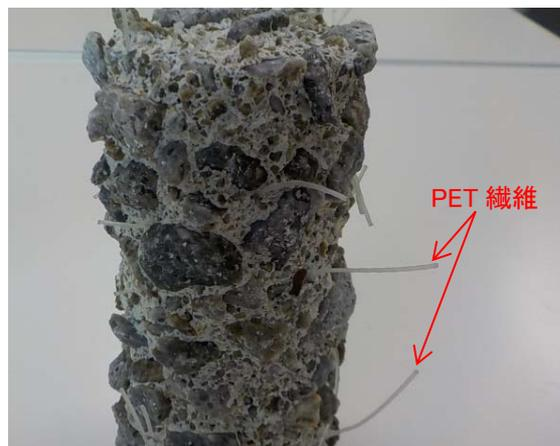
10%硫酸 28 日浸せき後供試体拡大写真
