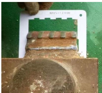
写真-2 側部の摩耗・チップの欠け
