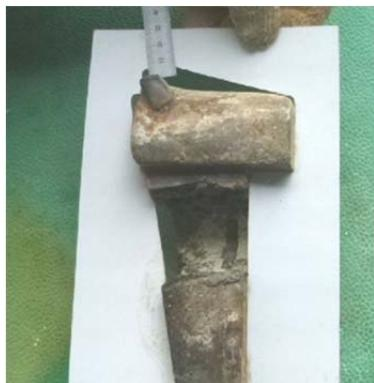
写真-1 ビット摩耗量測定
