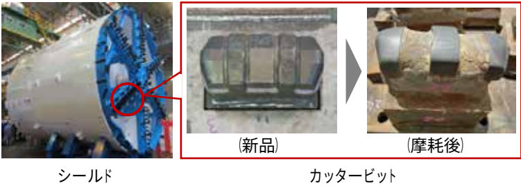
図-1 シールドカッタービットの摩耗
