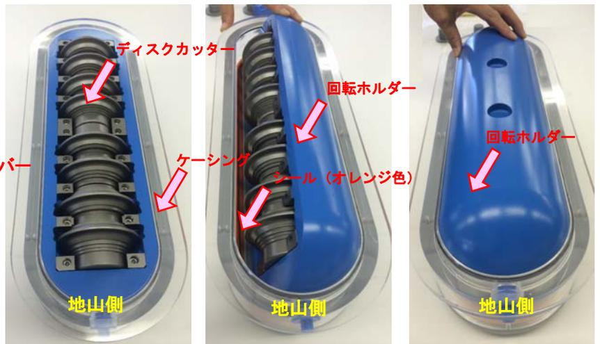
写真-1 ディスクカッターの交換概念
