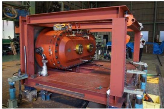
写真-3 ディスクカッターの交換装置（背面）
