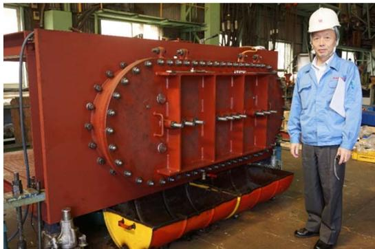
写真-2 ディスクカッターの交換装置（前面）
