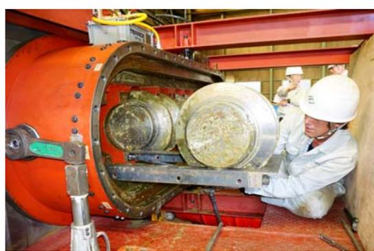
写真-5 ディスクカッターの引き出し
