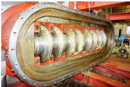
写真-4 ディスクカッターの交換前
