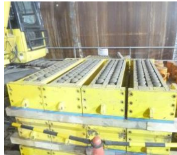
写真-3 ボールスライダー(右:設置状況)
