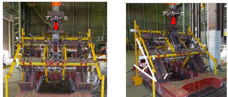
写真1 試験装置( $\alpha=45^\circ$  L=1.5m)
