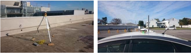
図-1 実験状況 (左：基準局 右：移動局)
