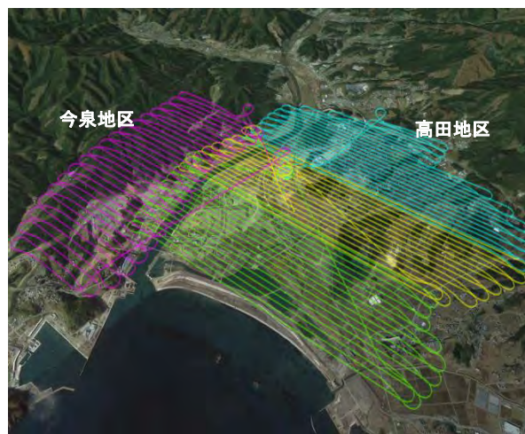
写真－2 UAV 飛行ルート (飛行時間 約 50 分/ルート)
