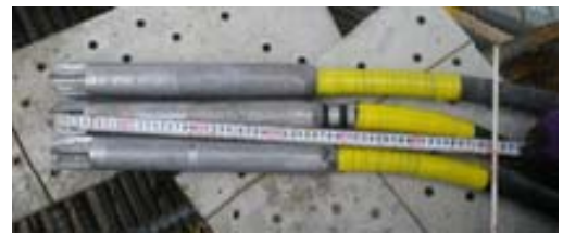
写真2 目印を設置したバイブレータ
