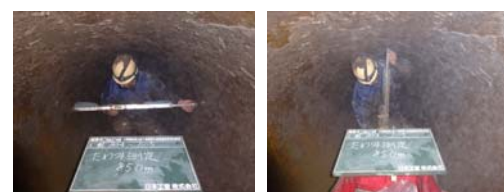
図-1 たわみ測定状況
