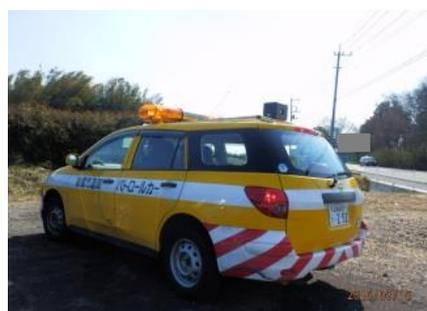
図5 市販カメラを搭載したパトロール車
