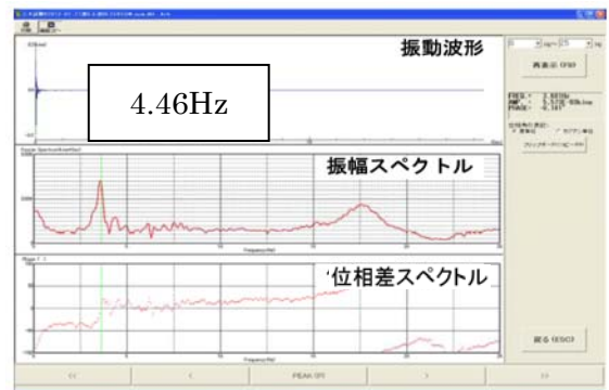
図-4 IMPACTシステムによる 衝撃振動試験解析結果例
