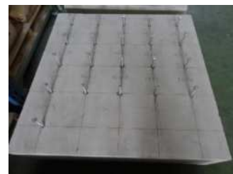
図-4 金属拡張アンカー試験体
