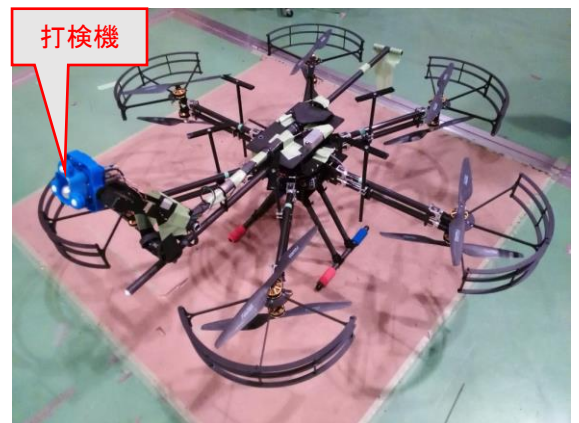
写真 1 打音検査用飛行ロボット
