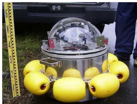
写真1 壁面自動追尾型水路トンネル撮影装置
