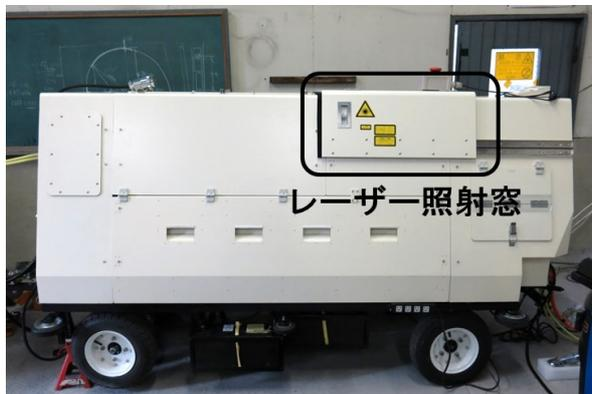
図6 小型化したトンネル中央通路走行型の実用的試作機
