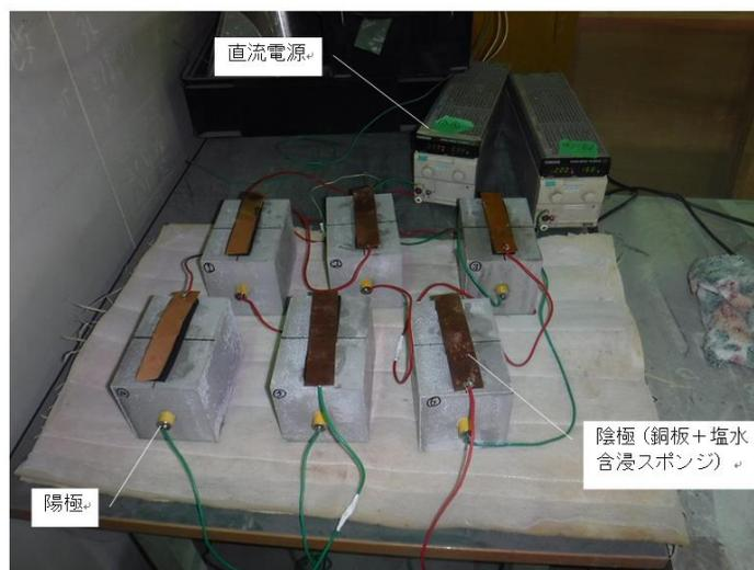
図2 鉄筋腐食方法
