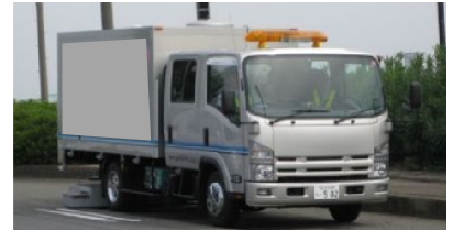
写真-1 電磁波レーダー測定車
