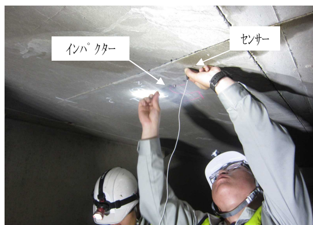
図1 衝撃弾性波による検査状況
