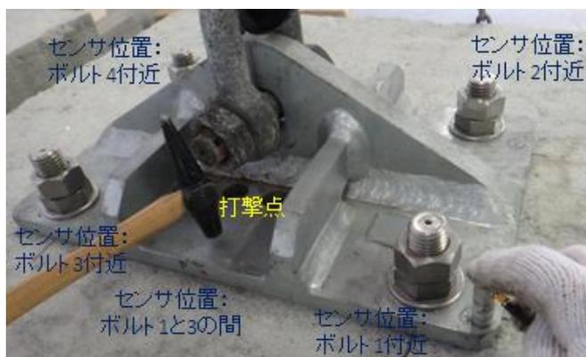
図 3 取付金具の打音検査におけるセンサ及び打撃位置
