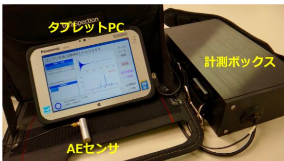
図 1 現場検査装置の構成及び外観
