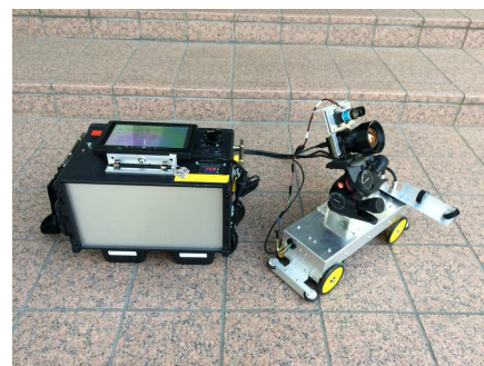
写真2 車輪式台車・制御装置
