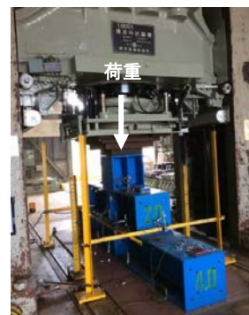
図6. 載荷試験状況
