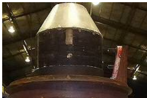
写真-3 実験時杭天端導入部
