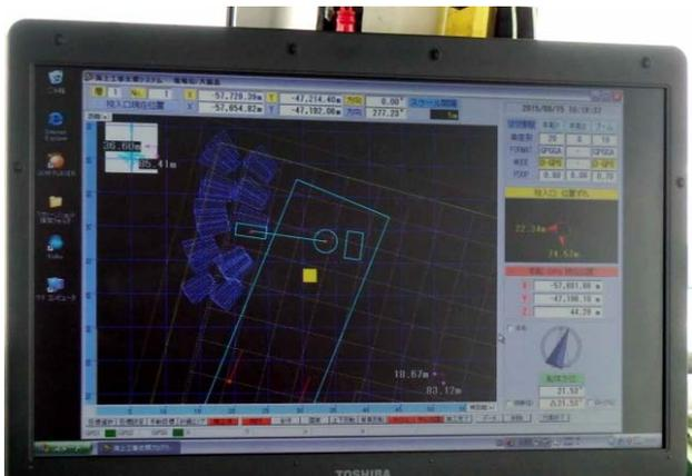
写真-1 GPS によるバケツ位置管理
