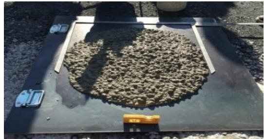
図-7 脱型後のシース部の充填状況
