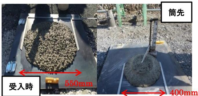
図-5 受入時と筒先でのスランプ試験結果
