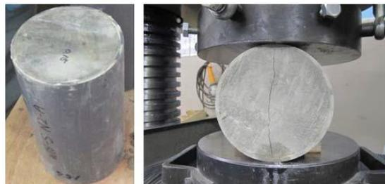
写真-1 ひび割れ模擬供試体作製状況
