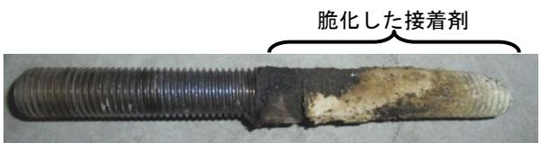
写真-3 加熱引抜後のステンレス製ボルト
