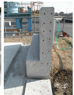
写真4 切断後の試験体状況
