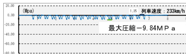
図-6 垂直補強部材コバ面応力(対策後)
